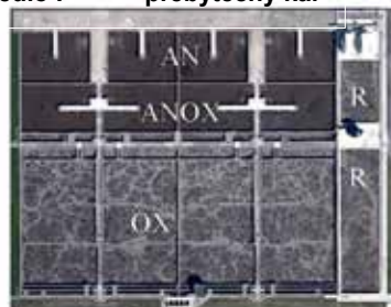
Obr. 6. Letecká fotografie (Google Maps) moderního aktivačního systému typu R-AN-D-N
